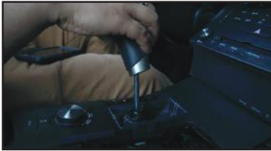
4. Remove the gear shift knob.
