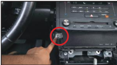
4. Remove the gear shift knob.
